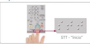
Se pueden adherir etiquetas Braille transparentes al panel de operación para ayudar a los usuarios a identificar las teclas físicas y las áreas comunes del dispositivo.
