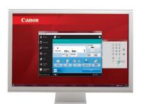
El panel de operación y la pantalla táctil se pueden emular en la pantalla de una computadora. Esto permite a los usuarios con movilidad limitada acceder y operar las funciones del sistema desde cualquier lugar a través de una computadora conectada a la red. Este software no es compatible con lectores de pantalla.
