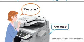
En algunos modelos imageRUNNER ADVANCE\*, los usuarios pueden navegar manualmente por el panel de operación y realizar funciones básicas como copiar, escanear\*\* y enviar faxes escuchando instrucciones audibles y utilizando el teclado.
